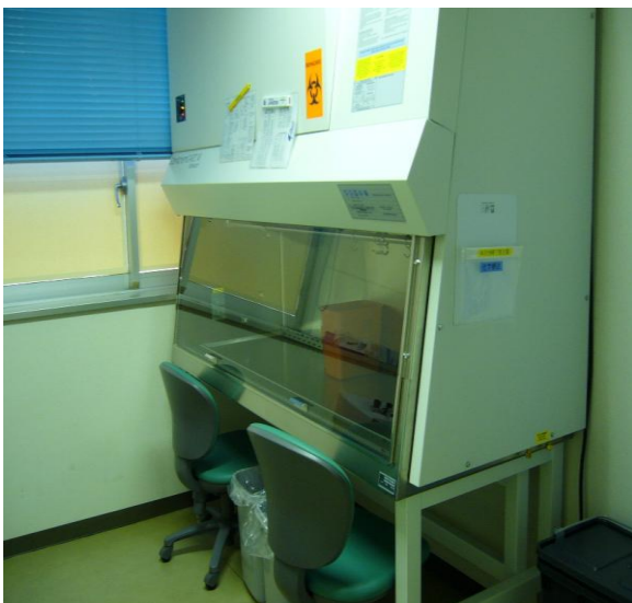
(写真1) 安全キャビネット
